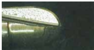
2 (B) c BNストレート刃エンドミル (2個加工後) No.2 (B) c BN Straight Endmill (after 2pcs. Cutting)
