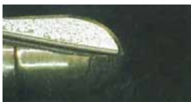
2 (B) c BNストレート刃エンドミル (2個加工後) No.2 (B) c BN Straight Endmill (after 2pcs. Cutting)
